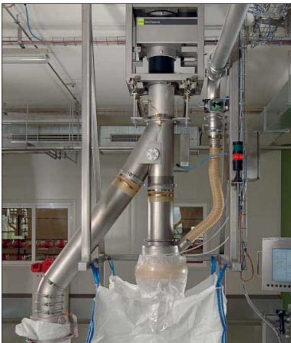
Máy dò kim loại tuân theo chuẩn IFS trực tiếp trước khi rót sản phẩm gia vị vào bao.
